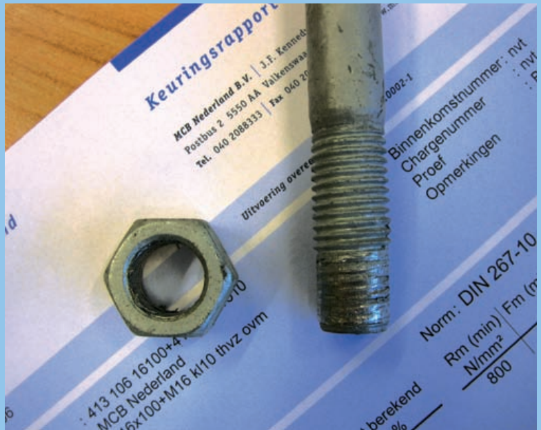
Thermisch verzinkte, overmaatse bout-moercombinatie M16x100 klasse 8.8 + M16 klasse 10, waarvan de schroefdraad is bezwaken.
