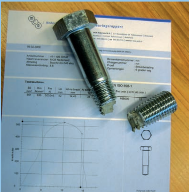
Elektrolytisch verzinkte bout M30x140 klasse 8.8, waarvan de boutsteel is bezwaken.
