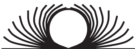
Afbeelding 1. Het vormen van een rond buisprofiel uit coil.
